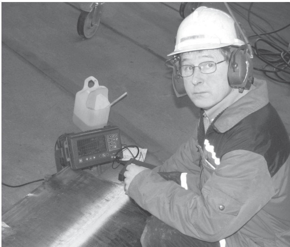
Rolf Opstad utfører Ultralydkontroll av en produksjonstest. Kalibreringsblokker med samme materialkvalitet og form er en helt klar fordel ved bestemmelse av plassering til eventuelle sveisefeil.
