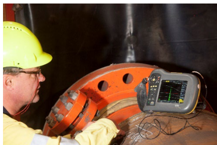
Sorin Erdei utfører UT på en reparasjon hos IKM Mekaniske (i dag Stavanger mekaniske)
