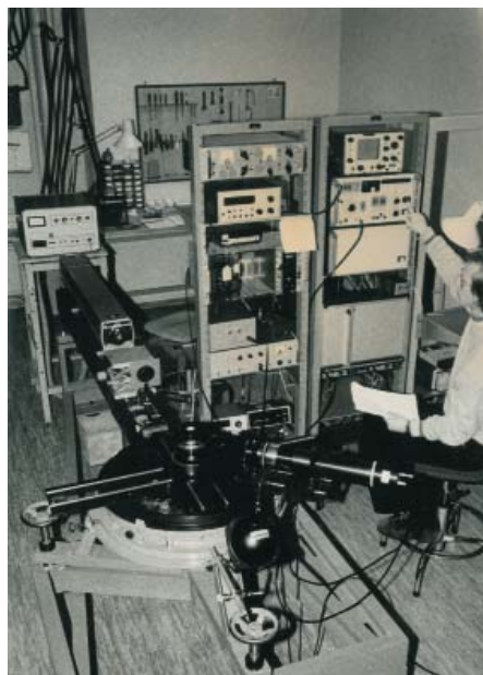
Fra prosjektet hvor vi studerte oppførselen til ladede partikler blandet i væske. Bildet viser bruk av Laser (blått lys fra Ar) som vi benyttet. Som vi ser var utstyret rimelig plasskrevende.
