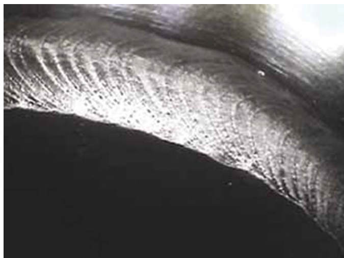
Konkav rod, bemærk skygge skal være på betragtnings siden af rodstrengen ellers er det gennemløb.
