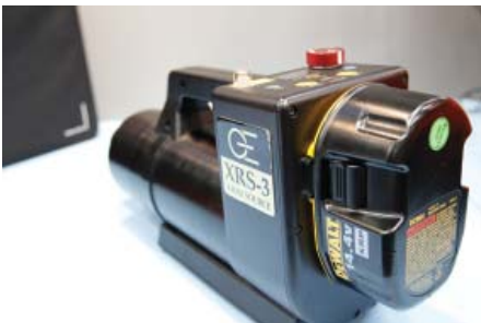
Rontgen kilde med batteri som kraftforsyning
