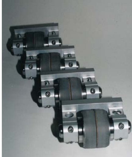
Disse lydhodene gjennomførte en PIG-tur fra Kårstø til Zeebrugge i Belgia med vellykkede målinger av veggtykkelsen. Statoil var vår samarbeidspartner.
