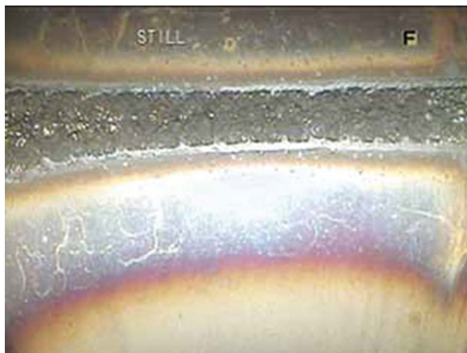
Koks og porøsiteter i roden, der er svejst uden baggas.
