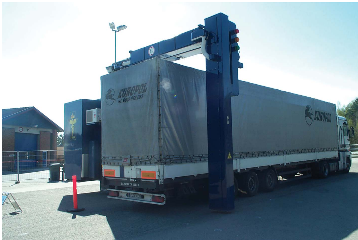
Bilde viser en akselerator for scanning av lastebil
