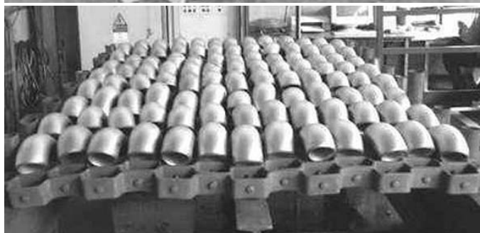
Figur 1. Varmebehandling i kurv (øverst) og tradisjonell varmebehandling på rist (nederst). Varmebehandling i kurv gir ikke jevn og tilstrekkelig høy løsningsglødetemperatur for alle komponentene i kurven, og sigmafase kan dannes for de deler som typisk befinner seg i midten av kurven.
