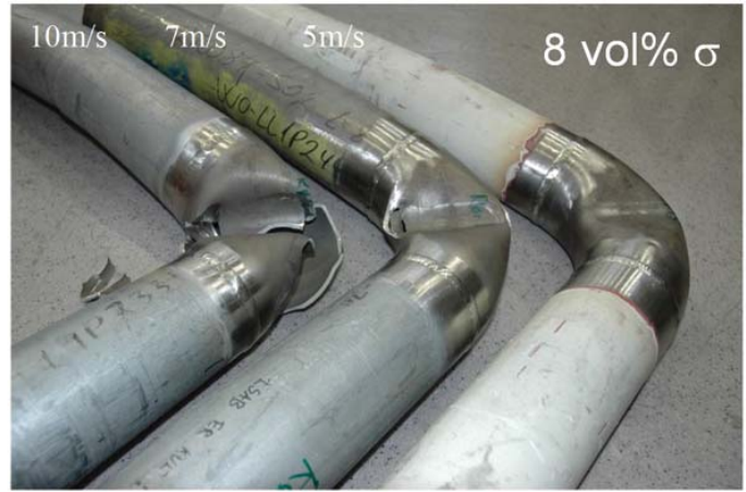
Figur 8. Bend med ca. 8 vol% sigmafase etterfølgende støt-testing ved ulike hastigheter.
