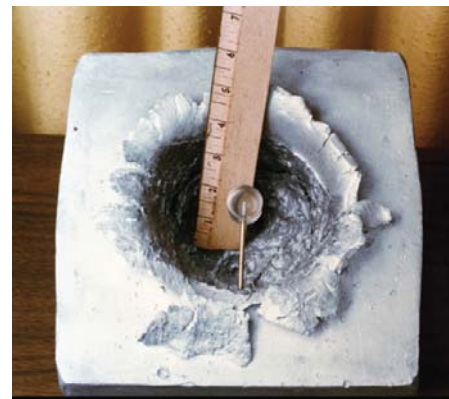
Bildet viser en aluminiumsbløkk etter den ble truffet av et 7 grams objekt med en fart av 7,7 km/sek (27 700 km/t)
