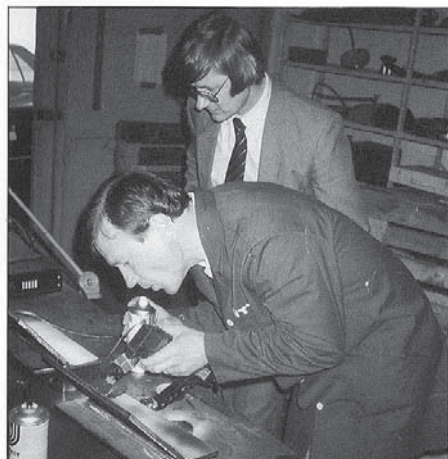
Okmagnetisering av ett svetsmetodprov. Ordförande för CEN 121 WG 5 Thomas Åström magnetiserar med ett ok, och arbetsgruppens sekreterare C-G Lindewald följer med provningen.
