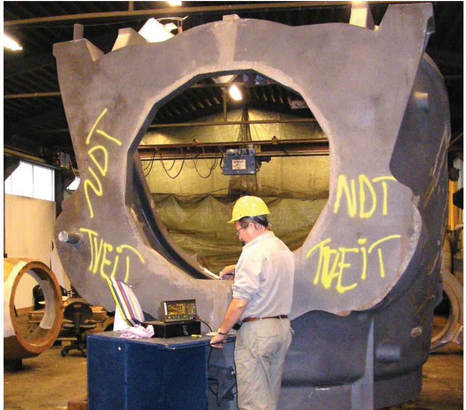
“Dette ser jo bra ut”. Inspeksjon av vindmøllekomponent.
