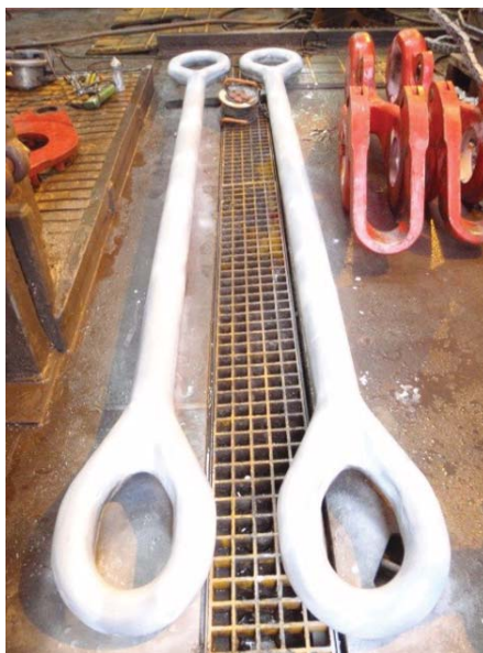
Elevator links inspeksjon
