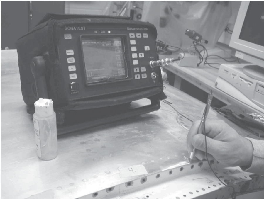
Tykkelsesmåling av 0.8mm aluminium
