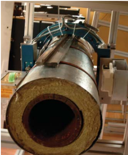
Fig. 4. Test opstilling med isoleret stålør med ældre rørcrawler, set forfra. Røntgenkilde og detektor er monterede på hver sin side af røret.
