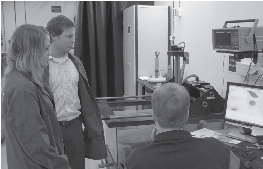
Kristiansen og Korsvold følger interessert med mens ultralyd-operatør Per Olav Evenrud (med ryggen til) forklarer bruk av ultralyd som inspeksjonsmetode for delamineringskontroll.
