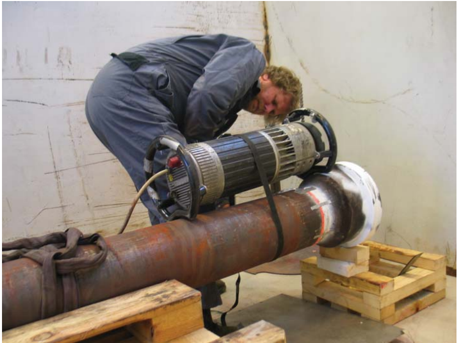
Radiografiprøving av termineringshode
