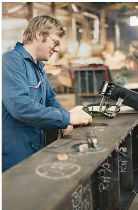
Johan Heggelund kontrollerer stålkonstruksjonene til helikopterdekket på Gullfaks B.
