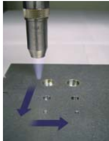
Generell stråleprofil og mønster for skanning
