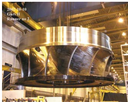
Guri Løpehjul. Høyde: ca 3,2. Diameter: ca. 7,5m. Vekt: ca 130 tonn
