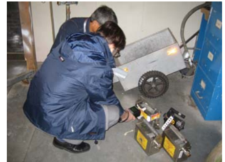
IAEA inspeksjon av skjermingsbeholdere av utarmet uran ved et NDT firma i Norge.
