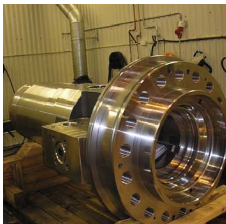
Bilde viser en body spool som klar for Magnetpulverprøving
