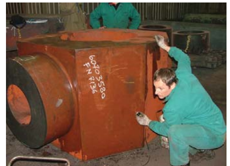
UT av smidd ventilbody hos leverandør i Italia
