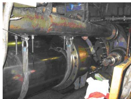
Hovedsylinder trekkes ut av sylindarhuset
