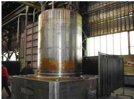
Ny smidd hovedsylinder i karbon mangan stål hos produsent i Italia
