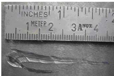
Mekanisk skade i overflate på hovedsylinder
