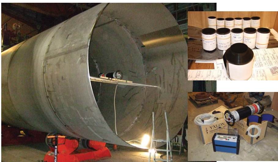
Bilde: Bruk av 300 kV helbølge rundstråler på trykktank. 17 m sveis eksponeres på 10 minutter.
