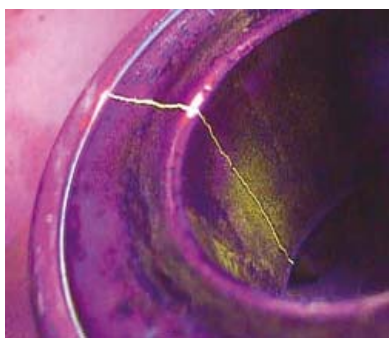
Figur 1 — Fotografering i synlig lys som viser magnetpulverindikasjoner under ultrafiolett lys: (a) høy oppløsning; (b) lav oppløsning. Lavere oppløsning gjør detaljene utydelige. Reduksjon av oppløsningen øker noen ganger kontrasten eller øker farge-toneintensiteten – tilleggs effekter er bedre arkivering av bildeprosessering som ikke ofrer detaljer.
