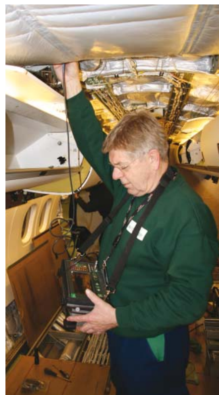
Ultralydproving av vinge bolter
