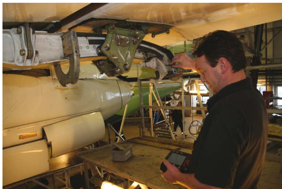
Virvelstrømproving av Flap track
