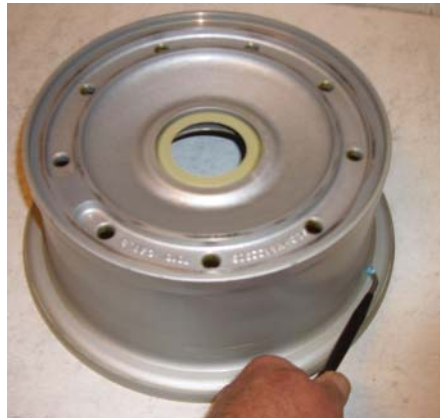
Eddy current insp. Bead seat område på felg
