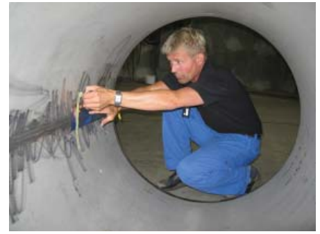
Artikkelforfatter håndterer film i forbindelse med radiografiprøving av en langsøm.
