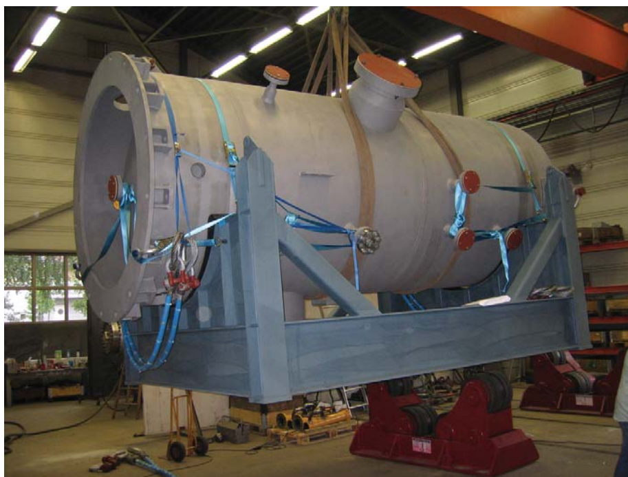
Scrubber til Kvitebjørn - 50mm Duplex
