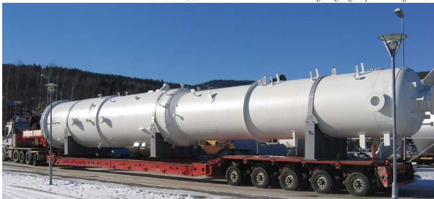
En MEG-Column opplastet på lastebil på veg til Shah Deniz
