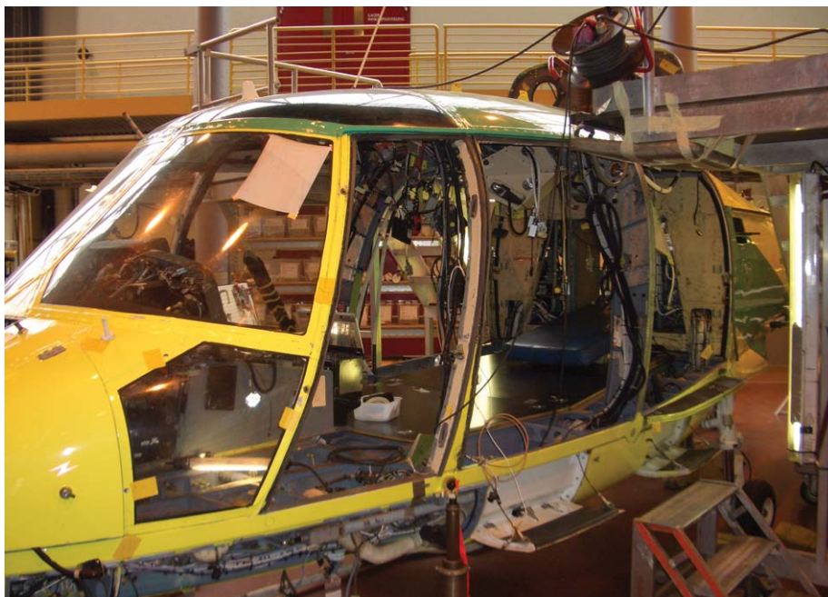
Detta er en Dauphin tilhørende svensk luftambulans som er inne for tungt vedlikehold.
