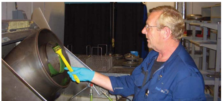
Artikkelforfatter Magne Clementsen smører penetrant på sveis eksospise
