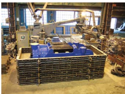
Her vises en tremodell av loadframe i en formekasse.
