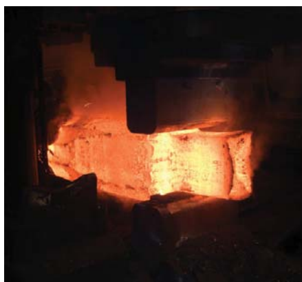
Starten på smiing av en 6,4ton blokk (utgangsemne)
