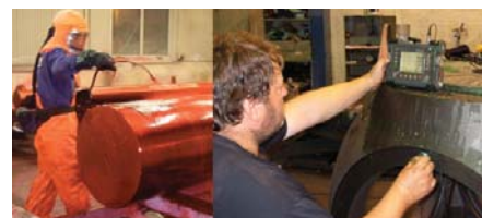
Her utføres PT av en smidd stang og ultralyd av et propellboss
