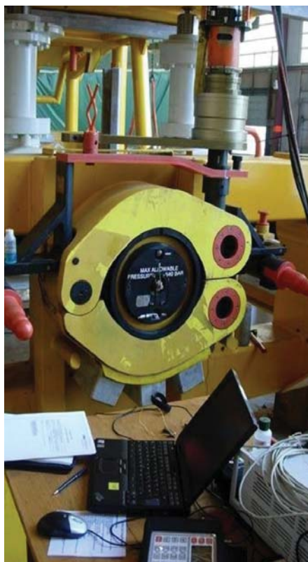
Bildet viser en clamp for en rørledning til Ormen Lange prosjektet
