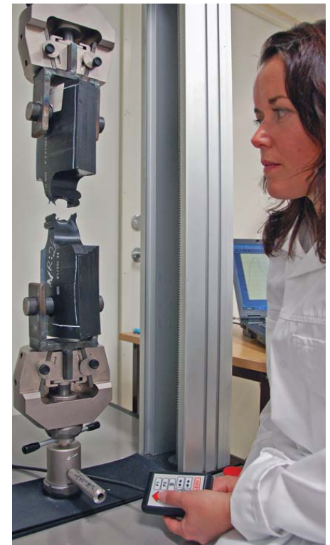
Mona Kirksæther Bekken utfører strekkprøving i TI's lokaler i Kongsberg. Her utføres det testing av alle mulige materialer fra stål til plastposer for vinmonopolet.
