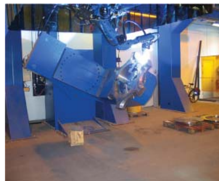
Sveising av hardbelegg i slitelommer
