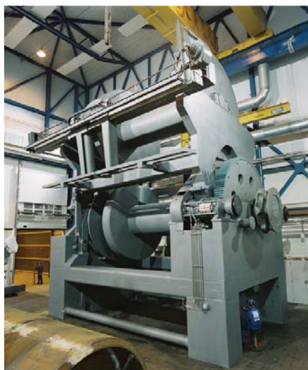
SL 600-2T Tåue og anker handterings' vinsj med elektrisk drift DC
