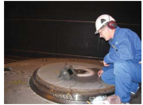
UT operatøren Rolf Opstad fra Midsund Bruk as kontrollerer ferdig sveis
