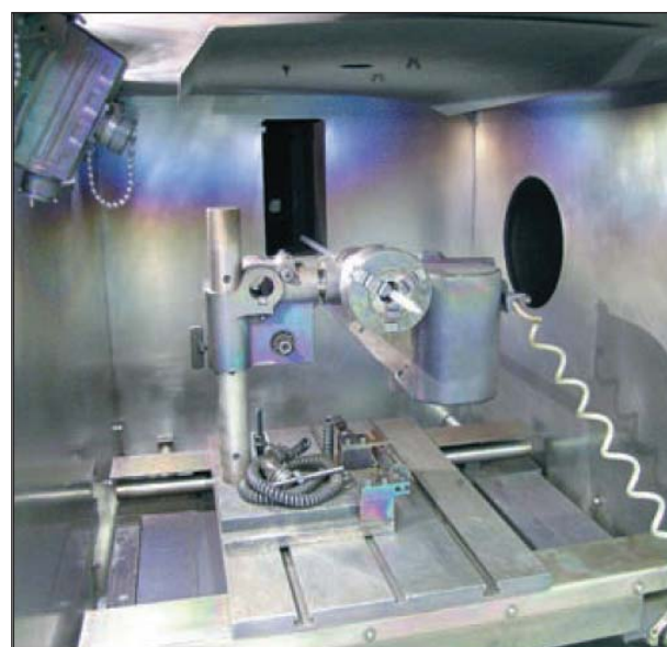
Brenselpinne for reaktoren på Kjeller montert i vakuumkanter klar for EB-sveising.
