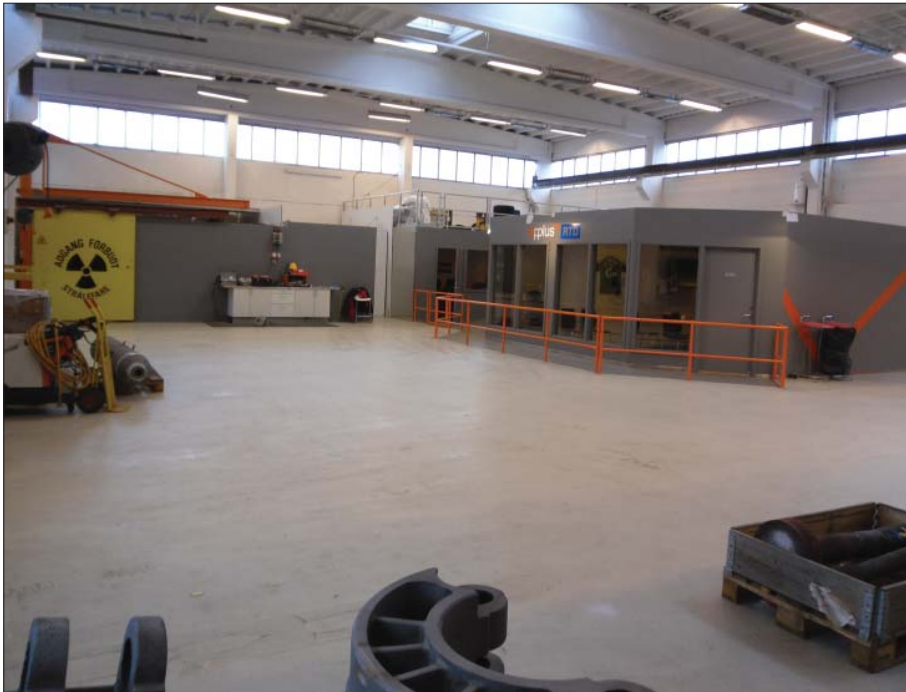
Fra det nye testsenteret i Stavanger. Testsenteret inneholder 2 røntgen bunkers, mørkerom for fluoriserende MPI, DPI stasjon og destruktiv testing laboratorie.
