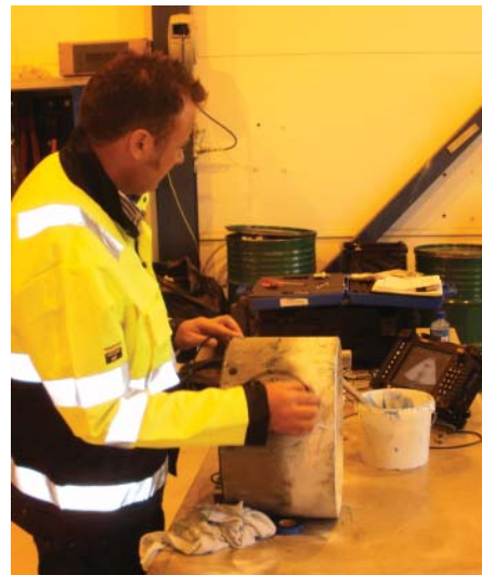
Her utfører jeg Phased Array ultralyd av subsea deler i Inspecta Ågotnes sine lokaler.
