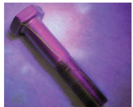
Her et bilde av en bolt med sprekke .
