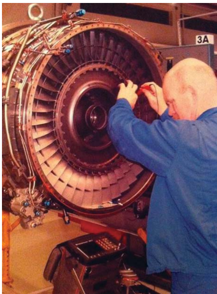
Artikkelforfatter foretar UT inspeksjon av 3. trinns disc på Inlet Fan Module til F100 motoren som står i F16
