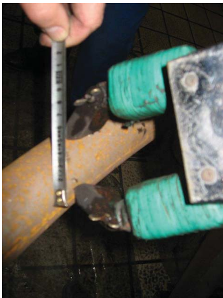
Yoke med legger rustet fast i avstand ca 40mm.
