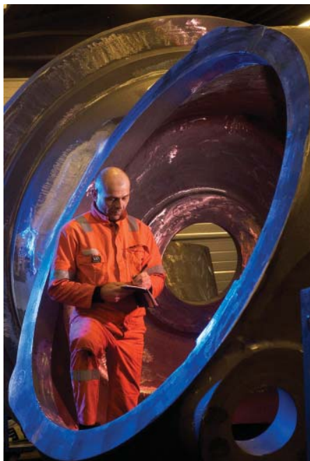
Sven O Hammen utfører visuell kontroll
