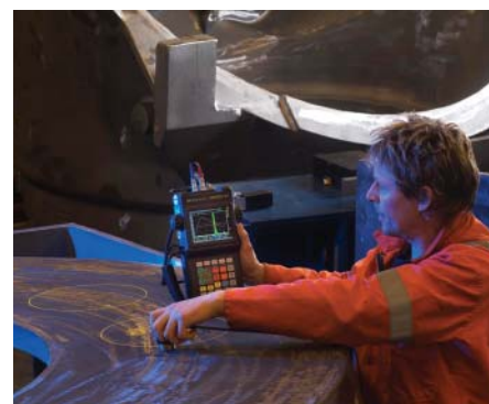
Vidar Thorsen i gang med ultralyd kontroll
