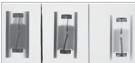
Sikringer som har løst ut på grunn av kortslutning.
