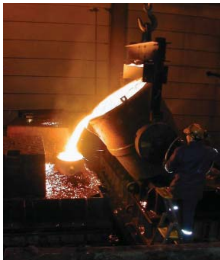
Støping av vindmølle gods
