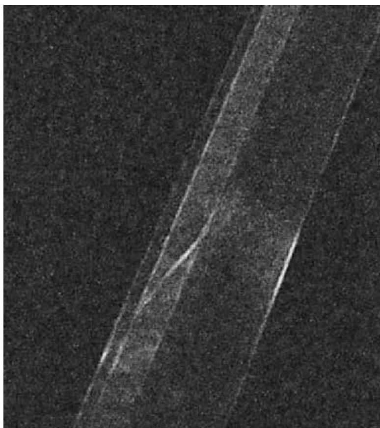
Bilde 2-2: Numerisk opptak av eksitasjon med enkel piezo-buzzer midlertidig festet med akustisk pasta. Objektet observeres på skrå slik at man ser hvordan vibrasjonene forplanter seg i materialet både i ytre skall og i indre kjerne. Skala på høyre side viser overflatens deformasjon i nanometer
