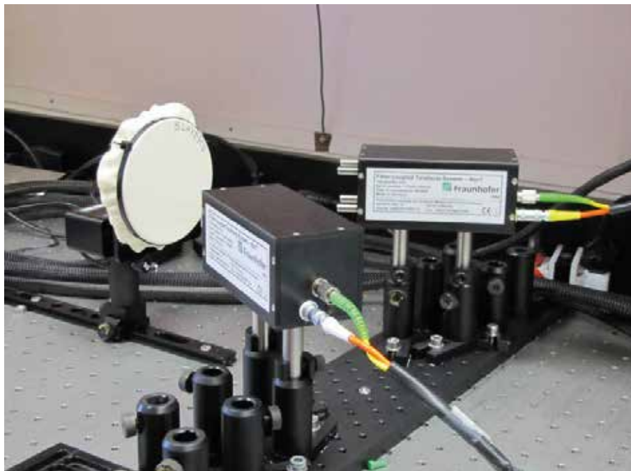
Figur 1. Oppsett for å måle reflekterte Terahertz-bølger fra en prøve. Utstyret inneholder et sender- og mottakerhode. I det viste oppsettet gjøres det en måling av et eksplosiv skjult bak fem lag med tøy.
