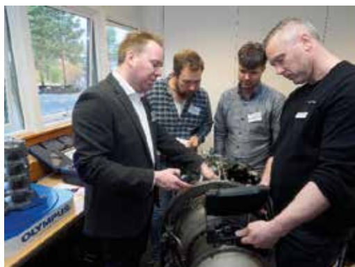
Visuell inspeksjon av Rolls Royce flymotor med Olympus RVI utstyr.
