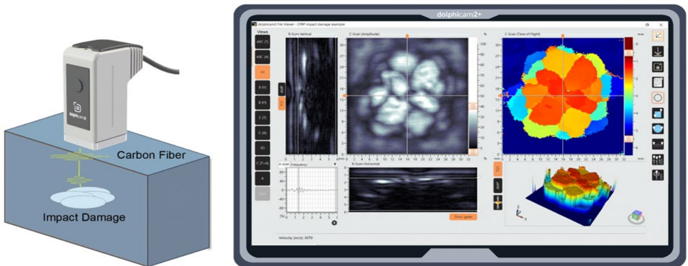
Figur 3 – dolphicam2 ultralydbilder av Karbon Fiber Slag Skade. A-scan, B-scan Vertikal, B-scan Horisontal, C-scan Amplitude, C-scan Time-Of-Flight, 3D bilde
