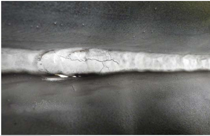
Foto: Salamonsen MT på sveiseprøve, utført av egne operatører.
