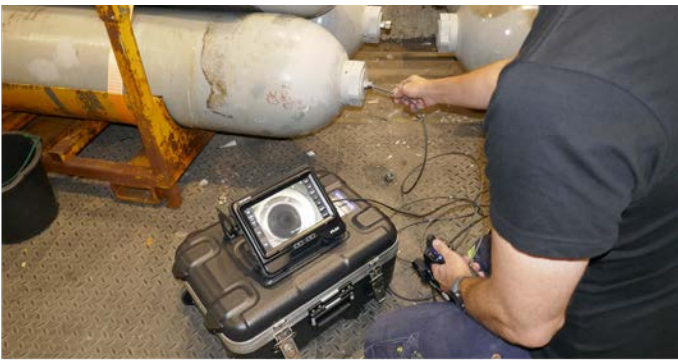
Foto: Ravnanger Videoinspeksjon av luftflasker utført av egne operatører.
